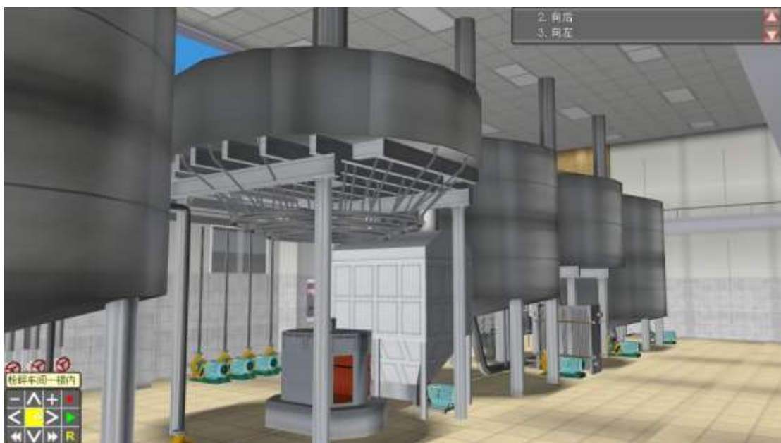
图 7 糖化车间沉淀槽等糖化设备图
